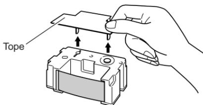
3. Si hay alguna flojedad en la cinta de tinta, utilice sus dedos como se muestra en la ilustración para girar el carretel del casete para quitar la flojedad.
