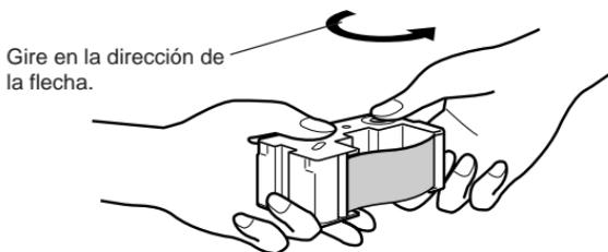
**4.** Coloque el casete de cinta de tinta dentro de la impresora.
