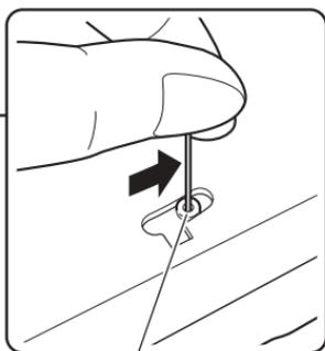
**Orificio de la palanca de liberación de la cabeza de impresión**
