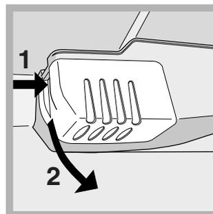
Îndepărtați protecția după indicațiile din figură pentru a ajunge la bec. Înlocuiți-l cu unul similar, a cărui putere să fie egală cu cea indicată pe capacul de protecție (15 W sau 25 W).
