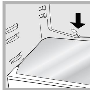
Frigiderul are un sistem de dezghețare automat: apa este dirijată în partea din spate a frigiderului, unde se află un orificiu de evacuare (vezi figura) de unde, cu ajutorul căldurii emanate, se evaporă. Singura intervenție pe care trebuie să o efectuați periodic constă în
