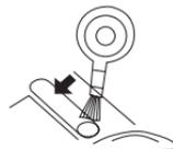
Limpie la lente periódicamente mediante un cepillo suave, (Del tipo de limpieza para lentes de fotografía). No toque la lente con los dedos. No presione la lente al realizar esta operación, ya que es un instrumento de precisión. Si no se siente capacitado para ello, lleve la unidad a un servicio especializado.
