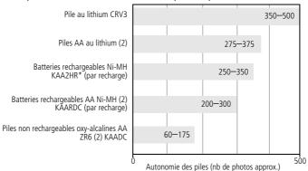
Autonomie des piles par méthode de test CIPA (Camera & Imaging Products Association) Carte mémoire utilisée lors des tests : carte mémoire SD 128 Mo Kodak
