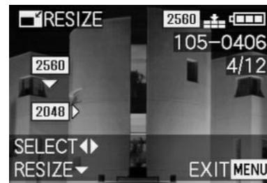
La procédure suivante n'est nécessaire que lorsque vous souhaitez réduire la résolution de plus d'un degré. Si ce n'est pas le cas, vous pouvez reprendre au point 6.
