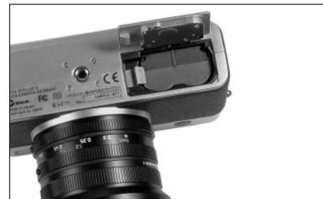
4. Fermez le couvercle du compartiment de l'accumulateur et tournez le levier de déverrouillage vers la gauche.
