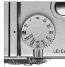
2. la molette de réglage de la vitesse d'obturation (1.16) également sur la position **A** (1.16 a).
