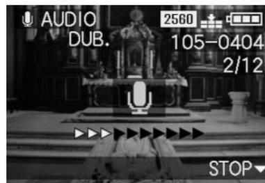
**Remarque:** Si la capacité de la mémoire est insuffisante pour l'ajout a posteriori d'un enregistrement sonore, la prise de vue à l'arrière-plan disparaît rapidement, le viseur/l'écran de contrôle vire au bleu et le message **NOT ENOUGH MEMORY ON CARD** s'affiche.
