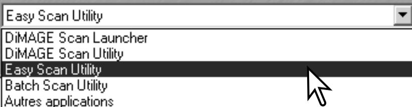
Le bouton Quick Scan peut être utilisé pour lancer une application directement. Sélectionnez simplement l'application depuis le menu déroulant, en haut du lanceur ; chaque fois que vous appuyez sur le bouton Quick Scan, le logiciel s'ouvrira.
