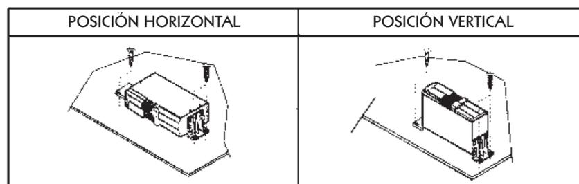
**IMPORTANTE:** Antes de efectuar los taladros asegúrese que por la zona no pasan cables, conductos o se encuentra el propio depósito de combustible. Ni que obstruye parte alguna propia del mantenimiento del vehículo.
