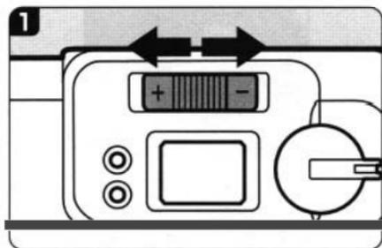
1. カメラを明るい方向に向け、ファインダーをのぞきながら視度調整レバーを左右に動かします。
