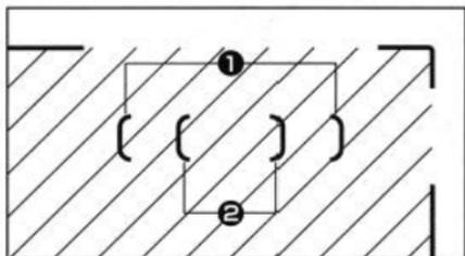
ファインダーをのぞくと、図のような表示が見えます。〔 〕表示は、ピントが合う範囲です。ピントを合わせたいものに〔 〕を合わせて撮影します。
