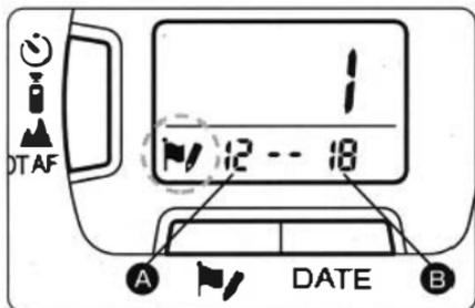
プリントされるタイトル表示は、表示パネルに図のように「A-B」の形で表示されます。
