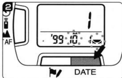
2. 【DATE】ボタンを一回押すごとに点滅表示が【年→月→日→時→分】の順に移動します。修正したい表示を点滅させてください。
