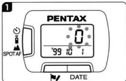
1. フィルムを最後まで撮り終わると自動的に巻き戻しが始まります。巻き戻しが終わるとモーターは止まり、図のように表示パネルの【0】が点滅して知らせます。
