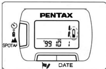
電池が消耗してくると表示パネルに【Q】マークが出て警告します。早めに新しい電池と交換してください。
