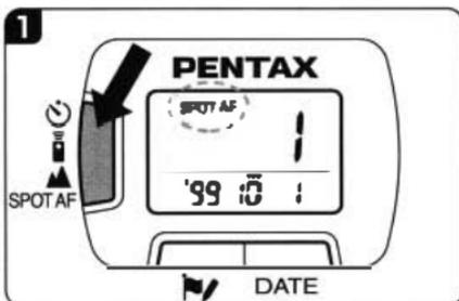
1. セルフリモコンボタンを押して、表示パネルに【SPOTAF】を表示させます。
