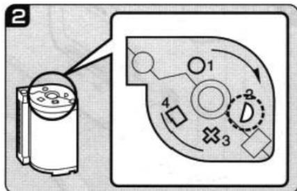
2. 途中巻き戻して取り出したカートリッジは、使用状態マークが撮影途中【D】になります。このカートリッジは、再度カメラにセットすることができます。
