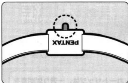
ストラップの図の部分は、フィルムの途中巻き戻しのときに使用します。[4]ページをご覧ください]
