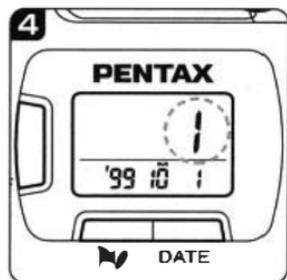
4. 表示パネルにフィルム枚数表示の【1】が出て自動的に止まります。必ず枚数表示が【1】になっていることを確認してください。
