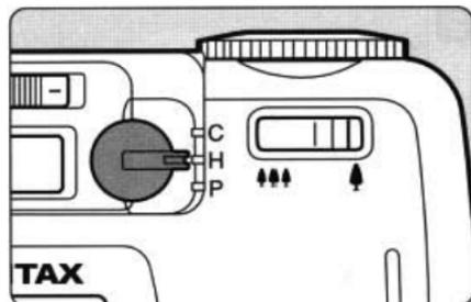
プリントタイプ切り替えレバーをC、H、Pのいずれかの位置にセットします。このカメラでは、作画意図に合わせ、撮影中でも自由に3種類のプリントタイプに切り替えることができます。
