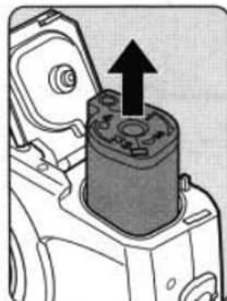
2. 表示パネルの【0】の点滅を確認後、カートリッジ室ぶた開放つまみを起し、左側に回してふたを開け、カートリッジを取り出します。
