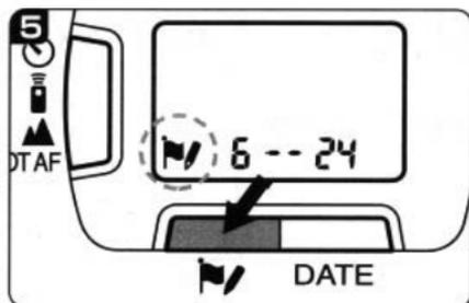
5. タイトルボタンを押して、表示の点滅をなくします。同時に表示パネルに【
