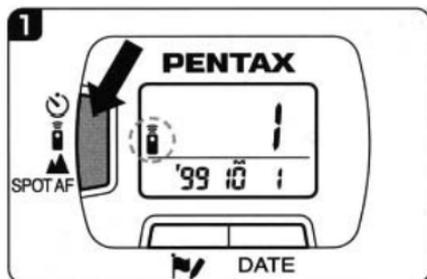
1. セルフ/リモコンボタンを押して、表示パネルに【i】表示させます。
