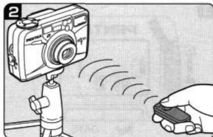
2. ファインダー内の【( )】を写したものに合わせ、リモコンをカメラ正面に向け、リモコンのシャッターボタンを押します。
