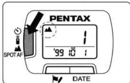
セルフリモコンボタンを押して、表示パネルに【▲】表示を出し撮影します。
