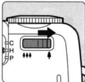
ズームレバーを【M】側に動かすと、遠くのを大きく写せる[望遠]69mm側になります。
