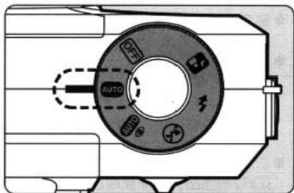
露出選択ダイヤルを回して【OFF】位置以外に合わせると電源が入ります。
