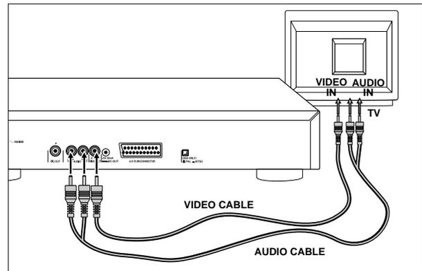
Anschluss an ein Fernsehgerät mit video-(CVBS bzw. FBAS)-buchse.
