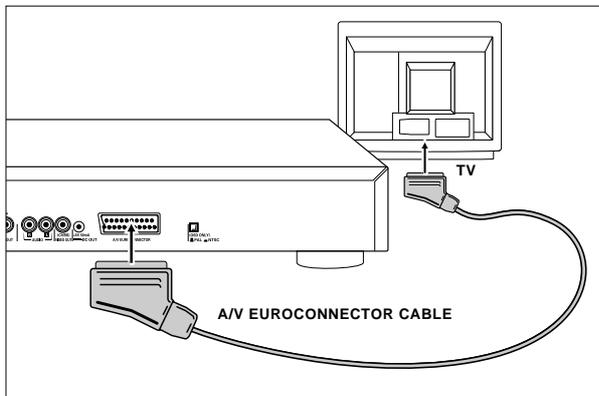
Anschluss an ein Fernsehgerät mit Euro-A/V-Anschluss.
