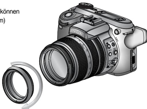
2. Montieren Sie die Gegenlichtblende durch Drehen im Uhrzeigersinn.
