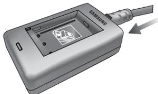
2. Coloque la pila en el cargador como se muestra al lado.
