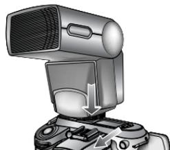
2. Coloque el flash girando la manilla del flash como se muestra al lado.
