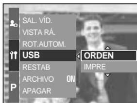
Si seleccionó [IMPRES], en el paso 6, cuando conecte la cámara a su PC, el mensaje [CONECTANDO IMPRES.] aparecerá y la conexión no se establecerá. In tal caso, scollegare il cavo USB, quindi seguire la procedura dal punto 3 in avanti.
