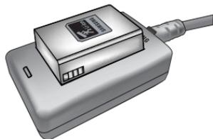
✿ Если индикатор зарядного устройства не мигает красным цветом или мигает желтым цветом, проверьте полярность подключения батареи.
