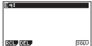
Den Ausdruck eingeben. Sie können Zahlen, alphabetische Zeichen und Operationssymbole eingeben. Falls Sie kein Gleichheitszeichen eingeben, nimmt der Rechner an, dass der Ausdruck links von dem Gleichheitszeichen steht und eine Null an der rechten Seite steht. Um einen anderen Wert als Null an der rechten Seite des Gleichheitszeichen zu spezifizieren, müssen Sie das Gleichheitszeichen und den Wert eingeben.
