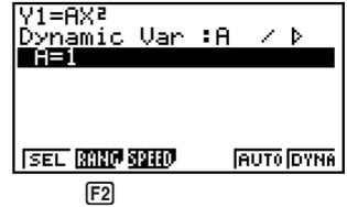
5. Die Tasten **F2** (RANG) **1** **EXE** **3** **EXE** **1** **EXE** drücken, um den Bereich und das Inkrement für die Änderung des Koeffizienten A zu spezifizieren.
