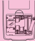
3. Entfernen Sie die Isolierfolie von der mit "BACK UP" markierten Stelle, indem Sie die Folie in die durch einen Pfeil gekennzeichnete Richtung ziehen.
