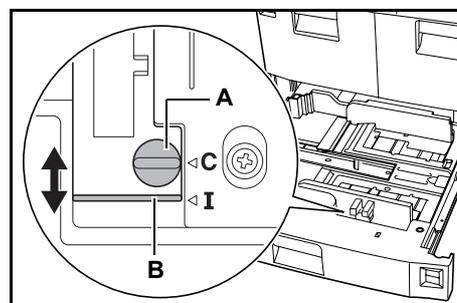
Gire el conmutador de ajuste de tamaño (A) 90 grados, de horizontal a vertical. ☉ → ⊕
