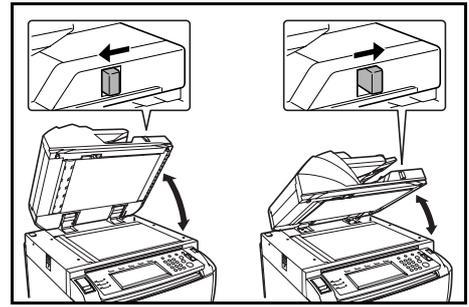
**IMPORTANTE:** Retire los originales del procesador de documentos antes de abrirlo. Los originales que quedan en la bandeja de originales o en la bandeja de expulsión de originales podrían caer cuando se abra el procesador de documentos. No mueva la palanca de ajuste del ángulo del procesador de documentos cuando el procesador de documentos esté abierto. Cierre el procesador de documentos antes de utilizar la palanca.
