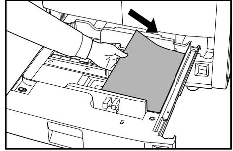
Las guías de ajuste de longitud y anchura deberían quedar contra el papel. Si hay una separación, reajuste las guías. Una separación puede producir atascos.
