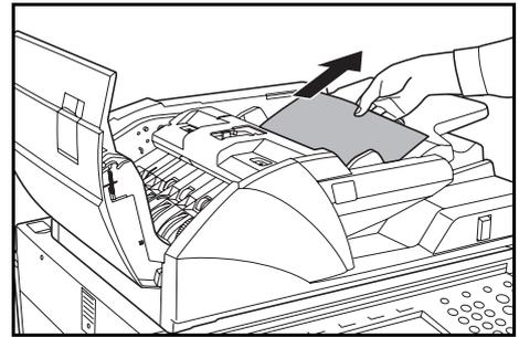
**4** Abra el procesador de documentos y, sujetando la palanca verde, abra la cubierta inferior del procesador de documentos.
