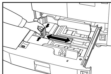
**3** Sujetando la lengüeta de ajuste de la anchura del papel por los dos lados, ajuste la guía al tamaño de papel correcto.
