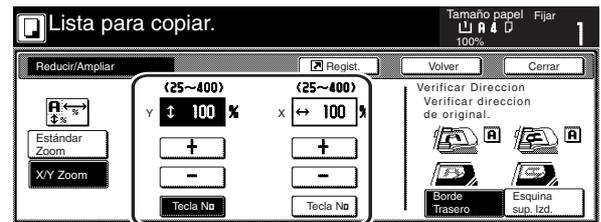
**5** Toque la tecla apropiada en el lado derecho del panel de toque para especificar el sentido en el que se colocó el original.
