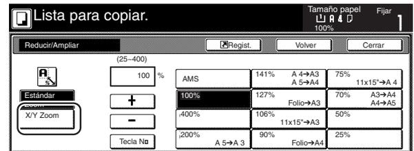
**4** Toque la tecla “+” o la tecla “-”, según corresponda, especifique el porcentaje de cambio de tamaño deseado para la longitud y ancho de la imagen. El porcentaje también puede entrarse directamente tocando la correspondiente tecla “Tecla N” y utilizando el teclado.
