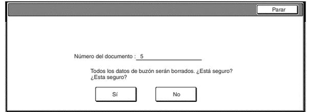
Si se seleccionó "Sí", se borrará todo el contenido del buzón seleccionado y el panel de toque volverá a la pantalla del paso 4.
