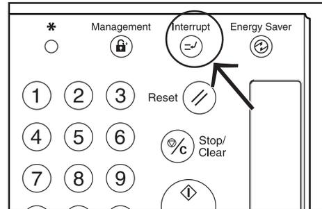
**1** Presione la tecla [Interrupt] para encender la lámpara en la tecla [Interrupt]. Aparecerá “Modo interrupción.”.
