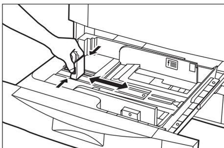
**3** Apriete las palancas de liberación y mueva las placas de guía del ancho de papel para alinearlas al ancho del papel colocado en esta gaveta.
