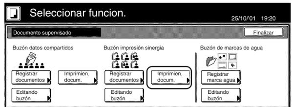
**3** Toque el buzón de impresión de sinergia que contiene los documentos a imprimir, o entre su número utilizando el teclado. A continuación, toque la tecla “Entrar”. Aparecerá la pantalla “Imprimiendo documentos”.
