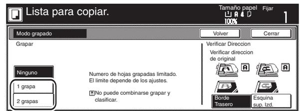
\* La posición de las grapas se mostrará en la imagen de las copias terminadas que aparece en el panel de toque, como se indica en la figura de abajo. Verifique el número y la posición de las grapas antes del copiado. Cuando la combinación de las funciones seleccionadas no permite el grapado, no aparecerán las marcas de grapas en la imagen.
