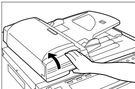
**2** Coloque el original cara abajo en el cristal de exposición y alinéelo con las líneas indicadoras de tamaño de original apropiadas del lado izquierdo del cristal de exposición.
