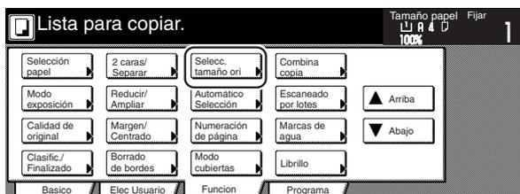
**4** Si desea seleccionar un tamaño de escanear normal, toque la tecla que corresponda al tamaño deseado y vaya directamente al paso 7.
