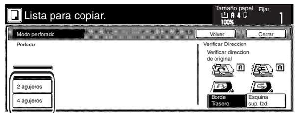
\* La posición de los orificios se mostrará en la imagen de las copias terminadas que aparece en el panel de toque, como se indica en la figura de abajo. Verifique el número y la posición de los orificios antes del copiado. Cuando la combinación de las funciones seleccionadas no permite perforar orificios, no aparecerán las marcas de orificios en la imagen.
