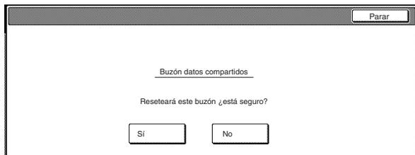
Si se seleccionó “Sí”, se borrará todos los datos en el buzón seleccionado y el panel de toque volverá a la pantalla del paso 1. Si se seleccionó “No”, el panel de toque volverá a la pantalla del paso 1 sin borrar ningún dato.
