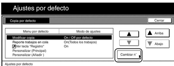
**3** Si desea la indicación de la tecla "Regist.", toque la tecla "On". Si NO desea sus indicación, toque la tecla "Off".
