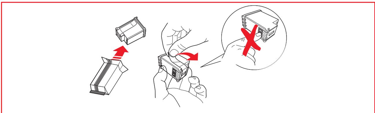
7 Prendre la cartouche d'encre avec les buses face vers le bas et les contacts face vers le côté postérieur de l'imprimante, et insérer la cartouche en couleurs dans le chargeur gauche et la cartouche noire ou photographique dans le chargeur droit.
