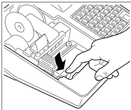
2. Sbloccare la testina di stampa esaurita premendo sulla levetta in direzione della freccia.
