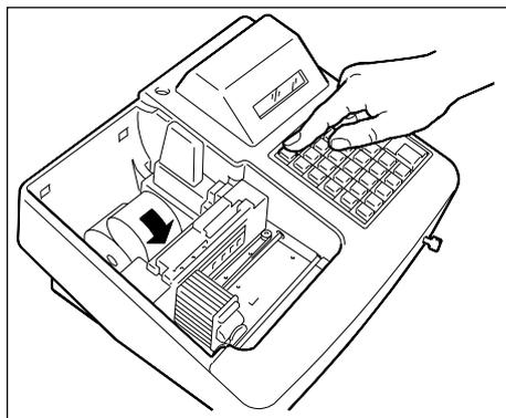
3. Posizionare il rotolo scontrino e inserire a fondo l'estremità nell'apposita fessura segnalata da una freccia, quindi premere il tasto SCTR per l'avanzamento del rotolo.
