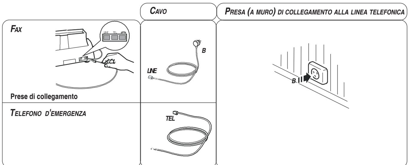
In caso d'impianto telefonico a prese multiple, puoi collegare altre apparecchiature telefoniche ad una qualsiasi delle prese disponibili purché il tuo impianto sia un impianto a più prese in parallelo, vale a dire: se il tono di linea, quando sollevi contemporaneamente i ricevitori degli altri apparecchi telefonici preesistenti, è sempre presente.
