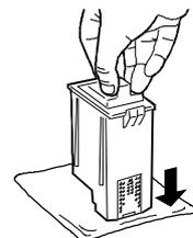
4. Ripeti alcune volte l'operazione, premendo la testina su punti diversi del fazzoletto per pulire accuratamente gli ugelli.
