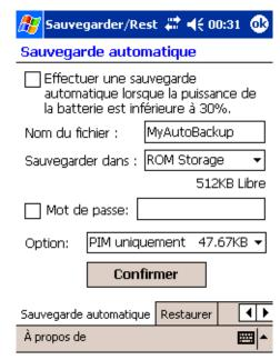
Lorsque la Sauvegarde automatique est activée et le périphérique de stockage spécifié n'est pas installé dans l'handheld lorsque le niveau de 30% de la batterie est atteint, la procédure de sauvegarde n'est alors pas effectuée.
