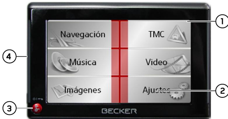
*Parte frontal del aparato con elementos de mando e indicación*
