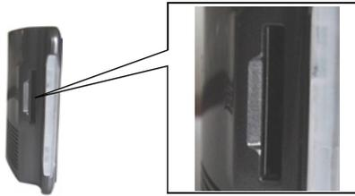
En la parte izquierda del aparato hay una ranura para la inserción de la tarjeta. El compartimento de la tarjeta va provisto de un mecanismo de enclavamiento y expulsión accionado por resorte.
