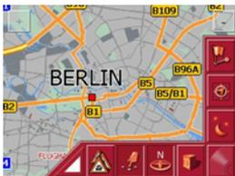
► Pulse suavemente la pantalla hasta que aparezca un círculo de puntos alrededor del destino especificado. Se registrará el destino y, a continuación, se cargará y se mostrará información sobre el punto seleccionado. Debajo del campo de información aparecen unos botones que permiten acceder a las distintas funciones disponibles para el punto de la ruta seleccionada.
