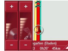
En los dos diagramas de barras se visualiza el volumen actual en comparación con el volumen máximo. El diagrama de barras de la izquierda indica el volumen de la música y el diagrama de barras de la derecha el de los avisos de voz.
