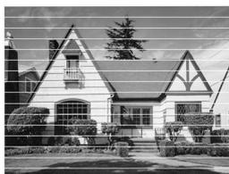
Si la boquilla del cabezal de impresión está obstruida, la prueba de impresión tendrá este aspecto.
