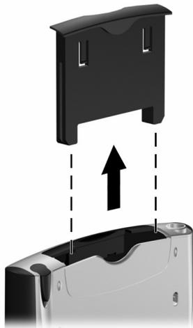
3. 将扩展卡插入相应的扩展槽中，用力将卡的连接端推入扩展槽。
