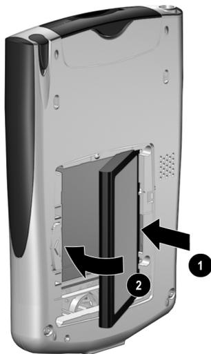
4. 装回电池盖，方法是将电池盖插入电池盖位置的卡舌中 ❶，然后合上并锁定电池盖 ❷。
