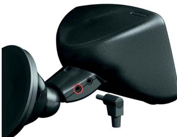
2. Collegare il cavo audio al connettore di ingresso dell'impianto stereo dell'auto.
