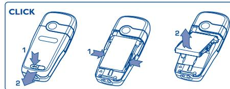
Lösen Sie den Akku aus dem Clip und entnehmen Sie ihn.
