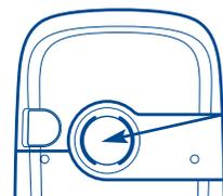
Im Freisprechmodus wird der Lautsprecher auf der Telefonrückseite automatisch eingeschaltet. Er besteht aus einer HiFi-Membran.
