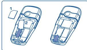
Legen Sie die SIM-Karte mit dem Chip nach unten ein und schieben Sie sie in die Aufnahme. Achten Sie darauf, dass die Karte bis zum Anschlag eingeschoben ist.
