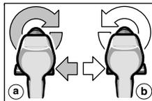
Com o comutador de sentido de rotação **8** é comutado o sentido de rotação da máquina. Se no entanto o interruptor de ligar/desligar **9** estiver accionado, isto não será possível.
