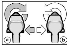
Suunnanvaihtokytkimellä **8** muutetaan koneen kiertosuunta. Käynnistyskytkimen **9** ollessa painettuna ei suunnanvaihtoa kuitenkaan voida suorittaa.
