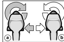
Le sens de rotation de l'appareil peut être modifié à l'aide du commutateur du sens de rotation **8**. Cela n'est toutefois pas possible en actionnant l'interrupteur Marche/Arrêt **9**.
