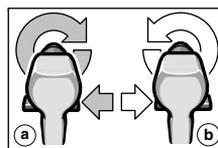
Tramite il commutatore del senso di rotazione **8** si cambia il senso di rotazione della macchina. Ciò non è possibile quando l'interruttore di avvio/arresto **9** è attivato.
