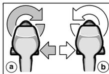
Med riktningso mkopplaren **8** kopplas maskinens rotationsriktning om. Vid påverkad strömställare Till/ Från **9** är detta inte möjligt.
