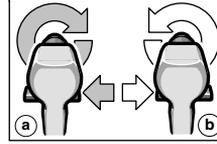
Dönme yönü deęiřtirme şalteri **8** ile aletin dönme yönü deęiřtirilir. Ancak açma/kapama şalteri **9** basılı iken dönme yönü deęiřtirme şalteri işlev görmez.
