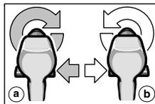
El selector de sentido de giro 8 sirve para invertir el sentido de giro de la máquina. Ello no es posible, sin embargo, si se mantiene presionado el interruptor de conexión/desconexión 9.
