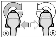
Højre-/venstreomskifteren **8** bruges til at ændre maskinens arbejdsretning. Det er ikke muligt at ændre maskinens arbejdsretning, når start-stop-kontakten **9** er aktiveret.
