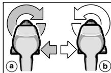
Med høyre-/venstrebryteren **8** endres maskinens dreieretning. Ved utløst på-/av-bryter **9** er dette ikke mulig.
