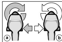
Mit dem Drehrichtungsumschalter **8** wird die Drehrichtung der Maschine umgeschaltet. Bei betätigtem Ein-/Ausschalter **9** ist dies jedoch nicht möglich.
