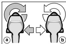
Met de draairichtingomschakelaar **8** wordt de draairichting van de machine omgeschakeld. Wanneer de aan/uit-schakelaar **9** wordt ingedrukt, is dit echter niet mogelijk.
