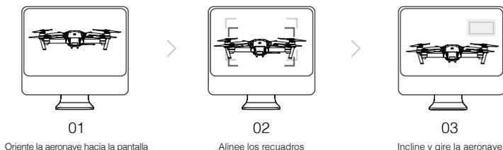
Repita los pasos anteriores para calibrar las cámaras del Sistema de Visión Inferior.
