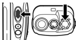
Con el transceptor apagado, presione el conmutador **PTT** prolongadamente mientras enciende el transceptor.
