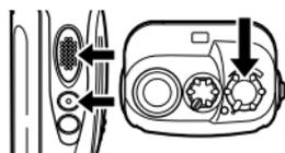
Con el transceptor apagado, presione el conmutador **PTT** y la tecla **Llamada** prolongadamente mientras enciende el transceptor.
