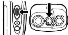
Presione y suelte el conmutador **PTT** y luego gire el selector de **Canals** hasta seleccionar el canal deseado.
