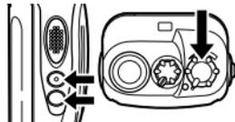
Con el transceptor apagado, presione la tecla **Llamada** o la tecla **Monitor** prolongadamente mientras enciende el transceptor.
