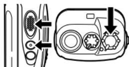
Con el transceptor apagado, presione el conmutador **PTT** y la tecla **Llamada** prolongadamente mientras enciende el transceptor.
