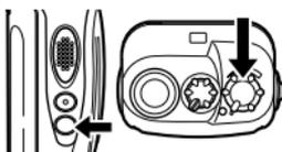
Presione prolongadamente la tecla **Monitor** para oír el ruido de fondo y luego gire el interruptor de **Encendido**/ control de **Volúmen** para ajustar el volumen.
