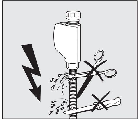
No corte la manguera de entrada. Contiene cableado eléctrico. Si corta la manguera, la lavavajillas no funcionará. Habrá fugas de agua y podría salir lastimado. Si la manguera es demasiado larga, enróllela muy bien y colóquela detrás de la máquina.
