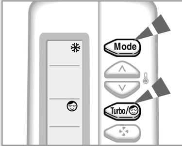
Ο χρονοδιακόπτης ύπνου μπορεί να χρησιμοποιηθεί όταν ψύχετε ή θερμαίνετε το δωμάτιο και θέλετε να σταματήσετε τη συσκευή αυτόματα μέσα σε μία περίοδο 6 ωρών.
