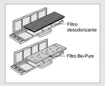
O aparelho pode ser equipado com o filtro desodorizante e de Bio-Pure para remover as particulas de poeira diminuta ou cheiros.
