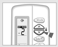
Pode colocar o aparelho de ar condicionado no modo automático, utilizando o telecomando. No modo automático, a temperatura do padrão e a velocidade óptima do ventilador é automaticamente seleccionada. Pode regular a temperatura do padrão, mas não a velocidade do ventilador.
