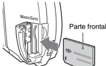
Presione hasta que quede completamente insertada.
