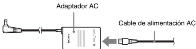
**2** Conecte el adaptador AC en el conector DC IN 5V de la parte inferior del sistema.
