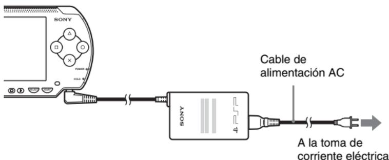
El indicador POWER (alimentación) se iluminará de color naranja, indicando que ha empezado la carga. El indicador POWER (alimentación) se apagará cuando se haya cargado completamente la batería.
