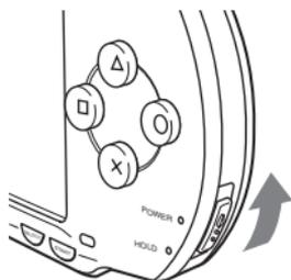
El indicador POWER (alimentación) parpadea, luego se apaga y el sistema entra en el modo de suspensión.
