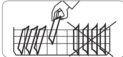
**Si es necesario colocar platos en el cesto superior:** ordénelos de atrás hacia delante; inclínelos ligeramente hacia delante y evite las posiciones frontales cerca de la puerta.
