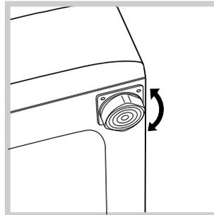
2. Compensare le irregolarità svitando o avvitando i piedini finchè la macchina non sia orizzontale (non deve essere inclinata più di 2 gradi).
