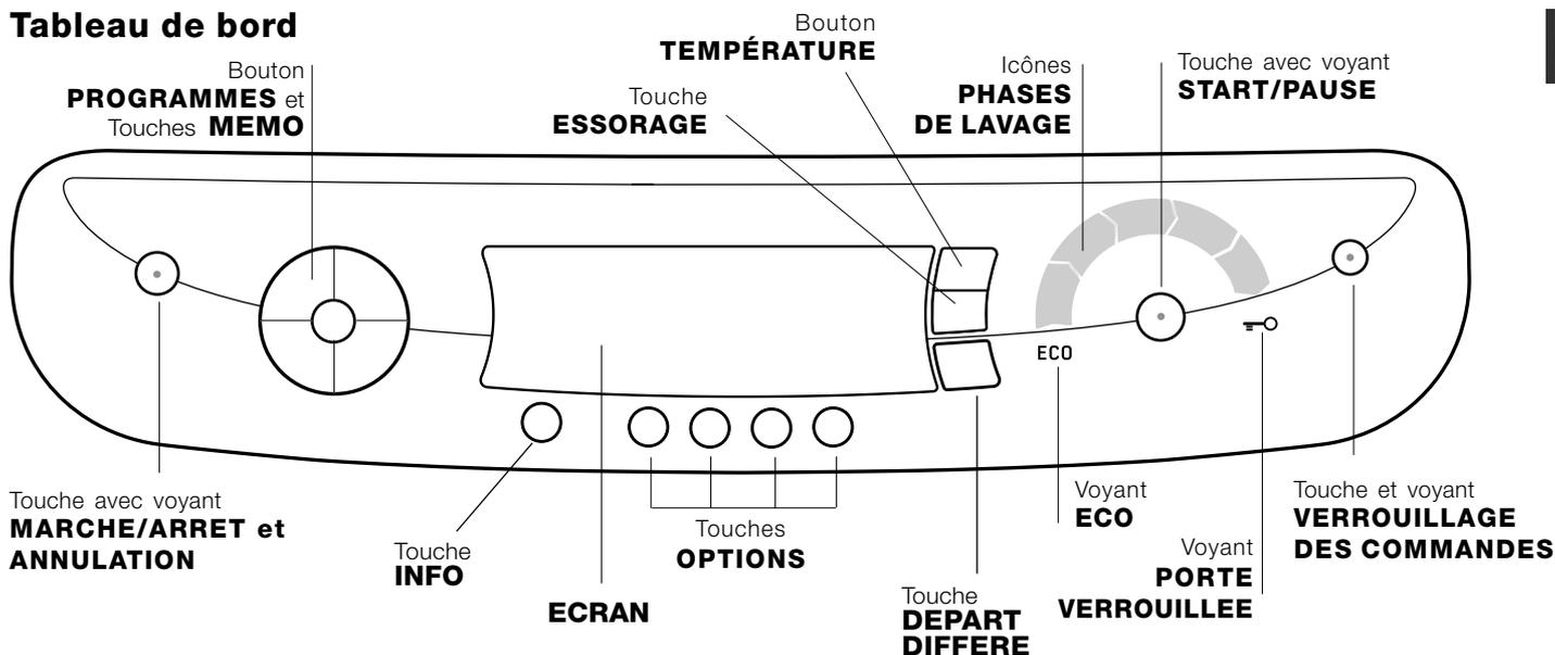
Touche avec voyant **MARCHE ARRET et ANNULATION**: appuyer brièvement sur la touche pour allumer ou éteindre l'appareil. Le témoin vert indique que l'appareil est sous tension. Pour éteindre le lave-linge en cours de lavage, appuyer sur la touche pendant au moins 2 secondes de suite; une pression brève ou accidentelle n'entraîne pas l'arrêt de l'appareil. L'arrêt de l'appareil pendant un lavage annule le lavage en cours.
