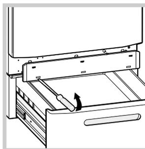
1. rimuovere il pannello di copertura sul lato anteriore della macchina con l'ausilio di un giravite (vedi figura);
