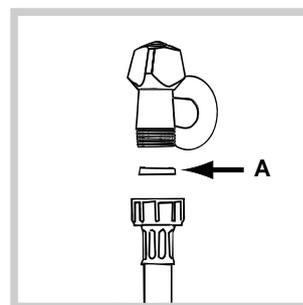
2. Inserire la guarnizione A contenuta nella busta nell'estremità del tubo di alimentazione e avvitarlo a un rubinetto d'acqua fredda con bocca filettata da 3/4 gas (vedi figura).
