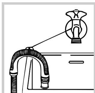
In alternativa, appoggiare il tubo di scarico al bordo di un lavandino o di una vasca, legando la guida in dotazione al rubinetto (vedi figura). L'estremità libera del tubo di scarico non deve rimanere immersa nell'acqua.
