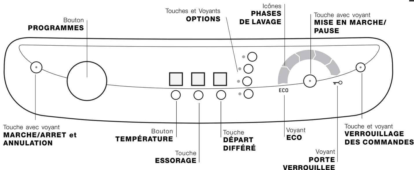
Touche avec voyant **MARCHE ARRET et ANNULATION**: appuyer brièvement sur la touche pour allumer ou éteindre l'appareil. Le témoin vert indique que l'appareil est sous tension. Pour éteindre le lave-linge en cours de lavage, appuyer sur la touche pendant au moins 2 secondes de suite; une pression brève ou accidentelle n'entraîne pas l'arrêt de l'appareil. L'arrêt de l'appareil pendant un lavage annule le lavage en cours.
