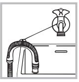
Una alternativa es apoyar el tubo de descarga en el borde de un lavabo o de una bañera, uniendo la guía suministrada con el aparato, al grifo (ver la figura).
