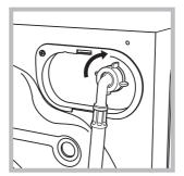
1. Conecte el tubo de alimentación a la máquina enroscándolo en la toma de agua correspondiente ubicada en la parte posterior derecha (arriba) (ver la figura).
