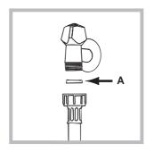
2. Introduzca la junta A, contenida en el sobre, en el extremo del tubo de alimentación y enrósquelo a un grifo de agua fría con boca roscada de 3/4 gas (ver la figura).
