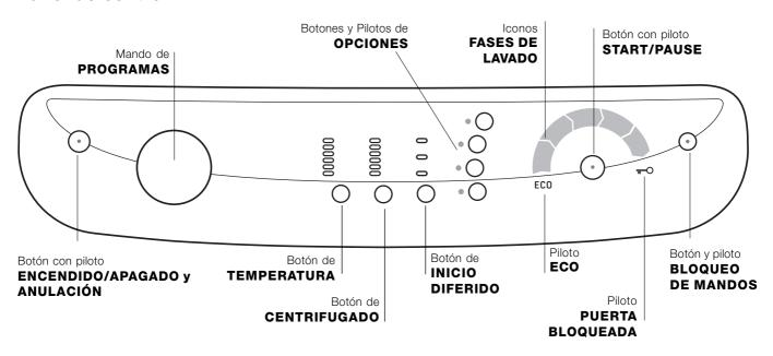
Botón con piloto (\*) **ENCENDIDO/APAGADO y ANULACIÓN:** presione brevemente el botón para encender o apagar la máquina. El piloto verde indica que la máquina está encendida. Para apagar la lavadora durante el lavado, es necesario mantener presionado el botón durante más tiempo, aproximadamente 2 seg.; si se presiona en forma más breve o accidental, la máquina no se apagará. Si la máquina se apaga durante un lavado en curso, dicho lavado se anulará.
