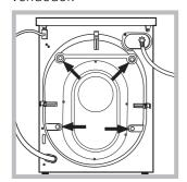
2. Quite los 4 tornillos de protección para el transporte y el correspondiente distanciador, ubicados en la parte posterior (ver la figura).
