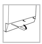
1. quite el panel de cobertura delantero de la máquina con la ayuda de un destornillador (ver la figura);
