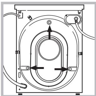
3. Αφαιρέστε τις τέσσερις βίδες μεταφοράς και το λαστιχάκι με το σχετικό διαχωριστικό, που βρίσκονται στο πίσω μέρος (βλέπε εικόνα).
