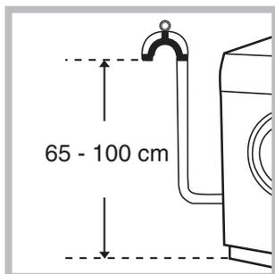
Podłączyć rurę usuwania wody, bez zginania jej, do przewodu ściekowego lub do ścieku w ścianie, które powinny znajdować się na wysokości od 65 do 100 cm od podłogi;
