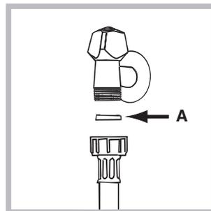
1. Coloque a guarnição A na ponta do tubo de alimentação e atarraxe-o a uma torneira de água fria com bocal de rosca de 3/4 (veja a figura). Antes de realizar esta ligação, deixe a água escorrer até estar límpida.
