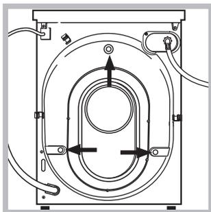
3. Tire os três parafusos para protecção no transporte e a borrachinha com o respectivo calço, situados na parte traseira (veja a figura).
