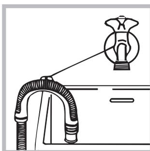
o apóyelo al borde de un lavabo o de una bañera, uniendo la guía suministrada con el aparato, al grifo (véase la figura). El extremo libre del tubo de descarga no debe permanecer sumergido en el agua.
