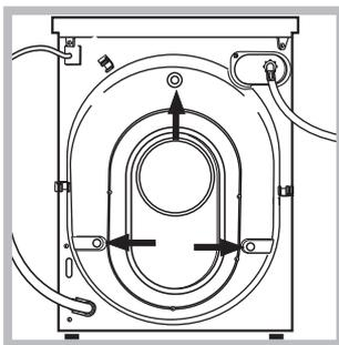
3. Quite los tres tornillos de protección para el transporte y la arandela de goma con el correspondiente distanciador, ubicados en la parte posterior (ver la figura).
