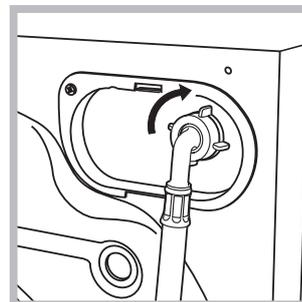
2. Csatlakoztassa a vízbevezető csövet a mosógéphez úgy, hogy azt a hátul jobboldalon fent lévő vízbemeneti csonkra csavarozza (lásd ábra).
