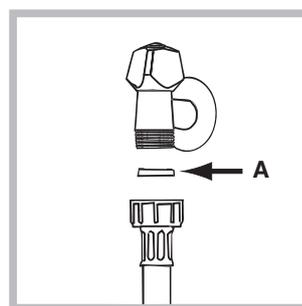
1. Εισάγετε την τσιμούχα A στο άκρο του σωλήνα τροφοδοσίας και βιδώστε τη μια βρύση κρύου νερού με στόμιο σπειρώματος 3/4 gas (βλέπε εικόνα). Πριν την σύνδεση αφήστε το νερό να τρέξει μέχρι αυτό να είναι διαυγές.
