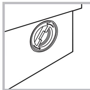
2. desenrosque la tapa girándola en sentido antihorario (ver la figura); es normal que se vuelque un poco de agua;
