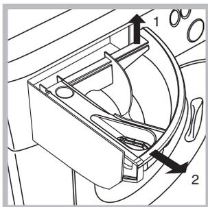
Extraiga el contenedor levantándolo y tirando hacia fuera (ver la figura). Lávelo debajo del agua corriente, esta limpieza se debe realizar frecuentemente.
