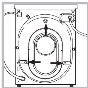
3. Odkręcić 3 śruby ochronne, zamocowane na czas transportu, oraz zdjąć gumową podkładkę z odpowiednią rozpórką, znajdujące się w tylnej ścianie i (zobacz rysunek).
