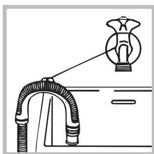
lub oprzeć ją na brzegu zlewu lub wanny, przymocowując do kranu załączony do pralki przewodnik (zobacz rysunek). Wolny koniec rury usuwania wody nie powinien pozostawać zanurzony w wodzie.
