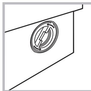
2. para desenroscar a tampa gire-a na direcção contrária aos ponteiros do relógio (veja a figura): é normal que perca um pouco de água;
