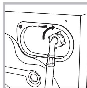
2. Podłączyć rurę pobierania wody do pralki, przykręcając ją do odpowiedniego otworu pobierania wody, znajdującego się w tylnej ścianie pralki, z prawej strony u góry (zobacz rysunek).
