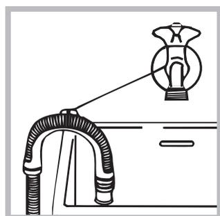
ou coloque na beira de um lavabo ou de uma banheira, prenda na torneira a guia fornecida (veja a figura). A ponta do tubo de descarga não deve permanecer emergida na água.
