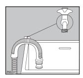
En una derivación del desagüe del lavabo. Esta derivación debe estar arriba del sifón, de modo tal que el recodo del tubo esté como mínimo a 60 cm del suelo.
