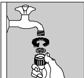
El tubo se suministra con la máquina y permite la conexión a un grifo provisto de rosca 3/4" gas. Para la correcta conexión, observar las siguientes instrucciones:
