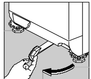
Nivele la lavadora atornillando o desatornillando las patas niveladoras.
