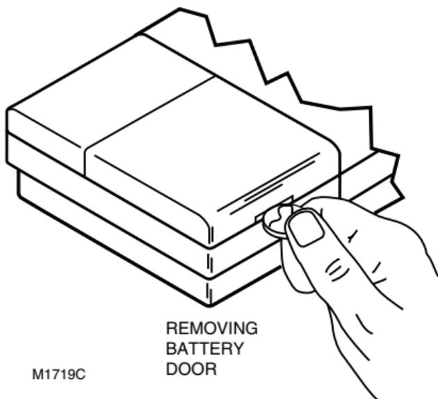
**Fig. 4. Battery Door Removal.**
