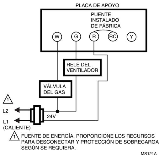
Fig. 5—Circuito T8602 de sólo calefacción de un sistema de petróleo.
