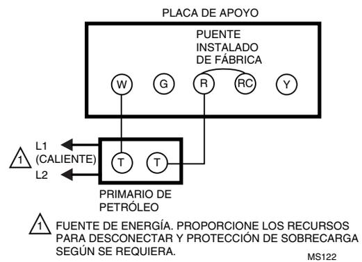
Fig. 6—Circuito T8602 de calefacción-refrigeración de un sistema de un solo transformador, de calor con gas y refrigeración eléctrica o bien de calor eléctrico y refrigeración eléctrica, terminales RC y R.
