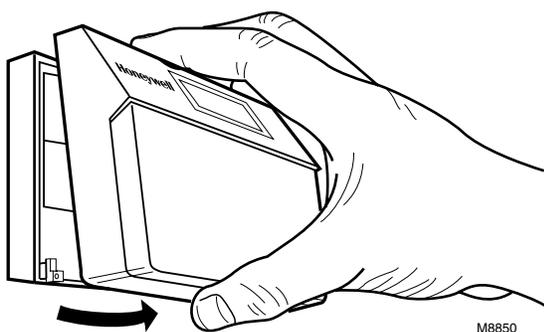
**Fig. 2—Para montar la placa de apoyo en la pared.**
