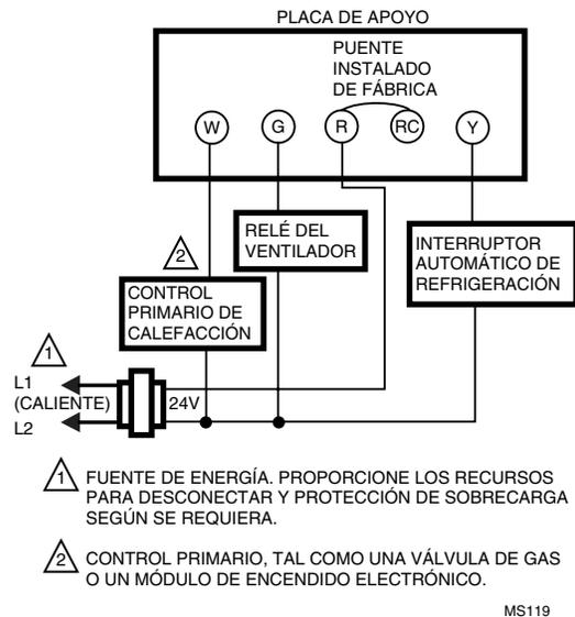
**Fig. 7—Circuito T8602 de calefacción-refrigeración de un sistema de dos transformadores (uno para calefacción y el otro para refrigeración) de calor con gas y refrigeración eléctrica, terminales RC y R. Quite el puente entre R y RC instalado de fábrica.**
