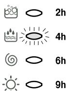
Naar gelang de terugloop van de tijd wordt , met het knipperen van het betreffende controlelampje de resterende tijd aangegeven:
