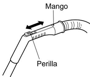
8. Pase suavemente la escobilla sobre el suelo. No ejerza excesiva presión sobre la escobilla, ya que esto podría dañar el suelo, especialmente las superficies de parquet. El óptimo resultado se obtiene aplicando una ligera presión sobre la escobilla. Si la escobilla ofrece resistencia al empujar, levante la parte delantera para disminuir la potencia de succión.
