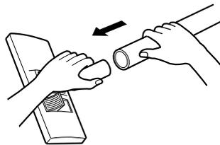
3. Inserte el extremo de la manguera dentro del cuerpo principal presionando el botón de sujeción hasta que ajuste. Para desmontar, presione el botón de sujeción y tire hacia fuera.
