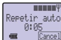
Se uma chamada falhar repetidamente, a repetição automática da marcação do número do telefone não será possível - terá que a remarcar-lo manualmente.
