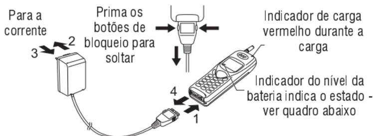
**Nota:** NÃO force a ficha, de forma a evitar danificar o telefone e/ou o transformador.
