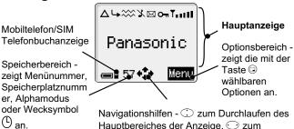
Nach Durchführung einiger Aufträge wird die Anzeige nach drei Sekunden automatisch oder durch Drücken einer Taste gelöscht.
