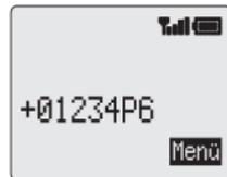
Die MFV Töne werden nach erfolgreicher Verbindung nach 3 Sekunden gesendet, oder aber durch Drücken von
