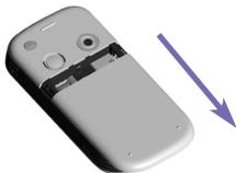
2. Cambie el bloqueo **rojo** de la batería para liberar la batería. Entonces utilice los dedos para levantar la batería desde el lado izquierdo de la ranura de la batería.
