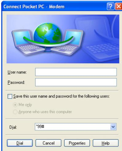
La próxima vez que desee marcar de nuevo desde su ordenador, haga clic en **Inicio > Configuración > Panel de control**, haga doble clic en **Conexiones de red**, luego haga doble clic en la conexión del módem.
