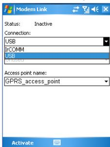
3. Para utilizar su dispositivo como módem GPRS, seleccione el **Nombre de punto de acceso GPRS**.
