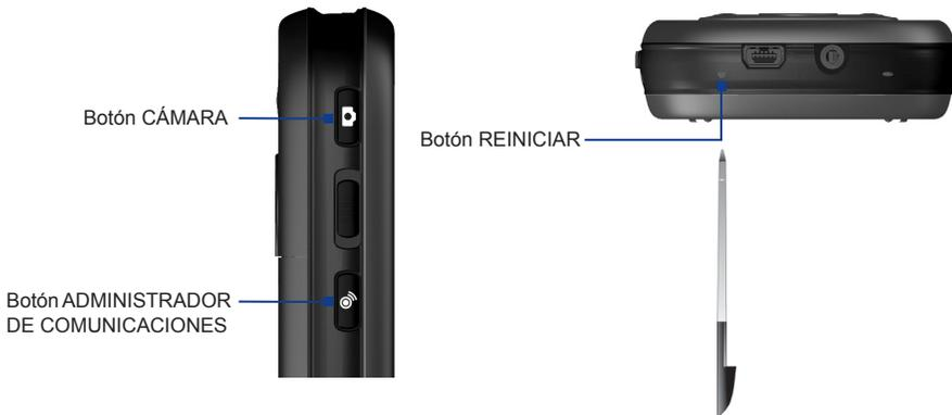
**¡Advertencia!** Apague siempre su dispositivo antes de realizar un restablecimiento duro. Su dispositivo volverá a los valores predeterminados de fábrica. Por favor, asegúrese de haber copiado cualquier aplicación adicional instalada y/o datos de usuario antes de realizar esta acción.
