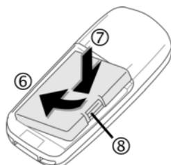
Para retirar, pressione a patilha de retenção ⑧ e de seguida retire a bateria.
