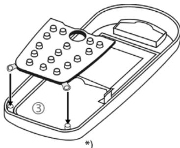
\*) Se nella parte inferiore del cover superiore sono presenti piccoli perni: posizionare esattamente le linguette di entrambi i lati del tastierino su questi perni. Solo allora eseguire il passo ④
